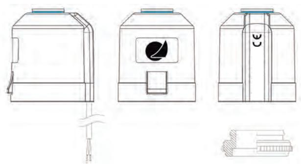
Válvula termoelectrica para la apertura y cierre de válvulas en los circuitos de suelo radiante.
