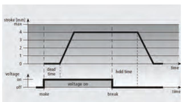
El actuador utiliza un termistor tipo PTC y un muelle de compresión. Este termistor se calienta mediante la aplicación de la tensión a 230V de funcionamiento y mueve un émbolo integrado. La fuerza generada por el émbolo se transfiere sobre la válvula, una vez transcurridos unos segundos (Dead time).
